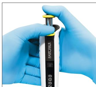
Za Tacta® pipetu je specifičan njezin Safe-Cone filter izbacivač, koji omogućuje uklanjanje korištenih filtera bez pincete ili ljudskog kontakta s kontaminiranim filterima.
