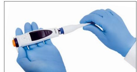
1. Odvijte prsten za izbacivanje nastavka u smjeru suprotnom od kazaljke na satu i uklonite ga. Uklonite Safe-Cone filter ako postoji.
