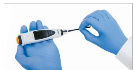
3. Odvrnite klip u smjeru kazaljke na satu od pipete.
