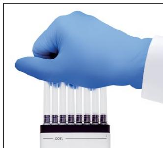
Optiloader za čvrsto prianjanje i jednako brtvljenje na konusnom vrhu svakog kanala
