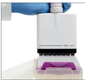
Pažljivo stavite nastavak u pipetu i iskoristite prednosti Optiload mehanizma za postavljanje nastavaka
