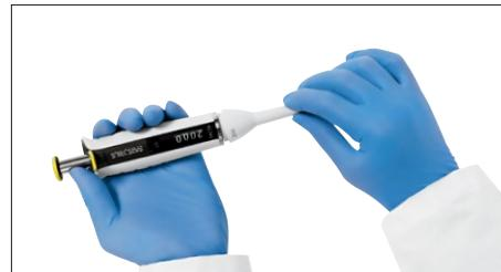
1. Odvijte prsten za izbacivanje nastavka u smjeru suprotnom od kazaljke na satu i uklonite ga. Uklonite Safe-Cone filter ako postoji.
