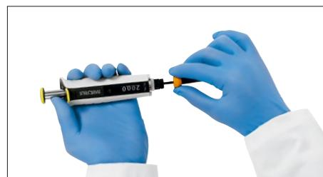
2. Odvijte držać konusnog vrha u smjeru suprotnom od kazaljke na satu i pažljivo ga uklonite zajedno s konusnim vrhom.
