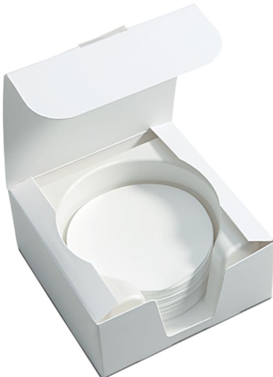
Ovi se filteri uglavnom koriste za nadzor zraka i plina ili kao predfilter. Proizvedeni su sa sintetičkim vezivnim sredstvima kako bi se osiguralo da filter ima definiranu čvrstoću. Mehanički su i kemijski stabilni, otporni na temperaturu do 180 °C i – ovisno o korištenom vezivnom sredstvu – hidrofobni ili hidrofilni.
