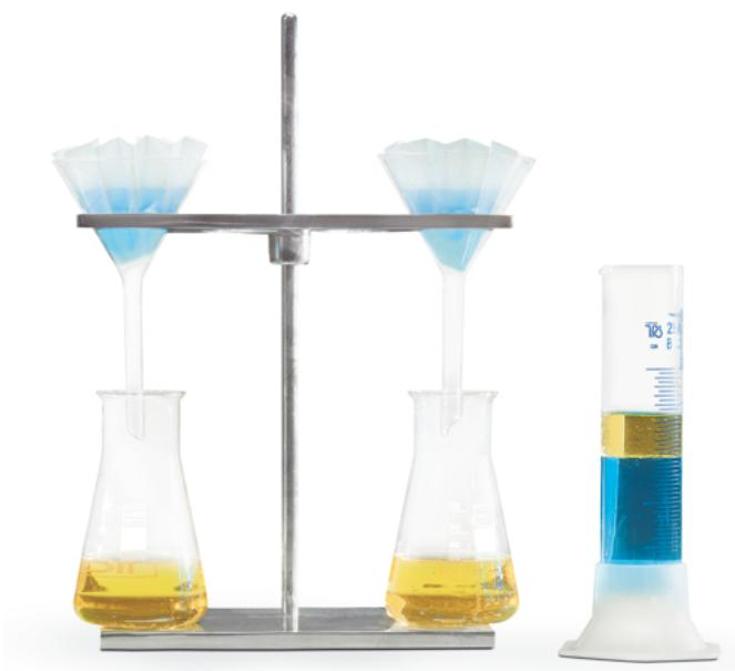
Razred 480 impregniran je stabiliziranim silicijem, što ga čini hidrofobnim: zadržava vodu, ali omogućuje protok otapala. Protok se automatski zaustavlja kad prođe cijelo otapalo. U mnogim primjenama, ovaj papir za odvajanje faza, eliminira potrebu za korištenjem lijevka za odvajanje.
