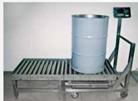
Posebna konstrukcija s transportnim kolicima za mjerenje teških bačvi.
