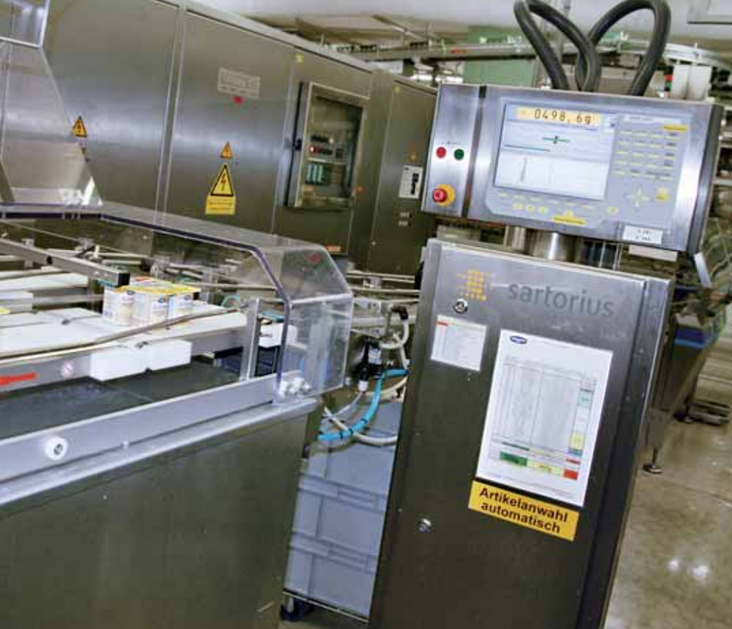
Kontrolna vaga EWK3010 preuzima kontrolu količine punjenja koju su ranije izvodili ručno svakih 20 minuta.
