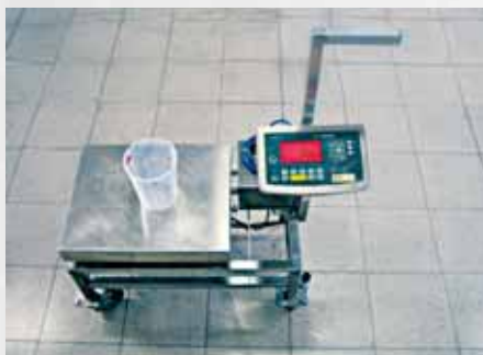
Ove male vage za doziranje savršeno su prilagođene mobilnoj primjeni: Čvrste su, imaju vlastito postolje za vožnju i bateriju prikladnu za eksplozivna područja.
