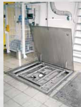
Podna se vaga lako otklapa kako bi se pri prosipanju lakova lako mogla očistiti.
