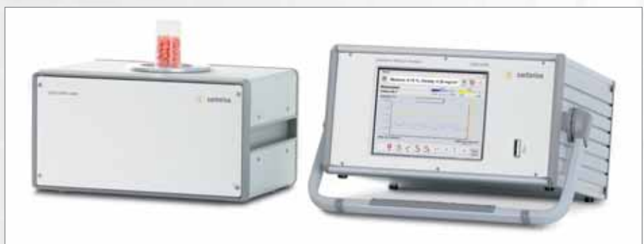
Novi LMA320 može utvrditi količinu vlage neovisno o gustoći.
