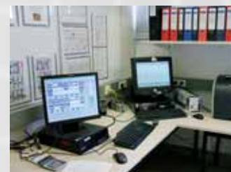
Kontrolnom vagom udobno se rukuje iz vlastitoga ureda. Kontrolna vaga i sustav za kontrolu kvalitete preuzimaju 16-znamenkasti SAP-ov broj proizvoda.
